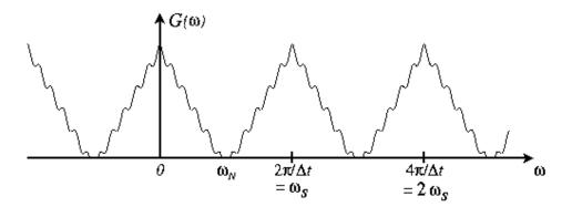
Maintenant, si l'on veut reconstruire le signal analogique à partir du signal échantillonné, on voit qu'il suffit de se débarrasser des copies latérales du spectre. Pour ce faire, on peut théoriquement utiliser un filtre passe-bas idéal (une fonction rectangulaire) qui vient isoler le spectre original de ses copies latérales.
