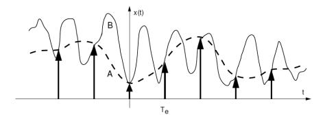
La figure ci-dessus illustre bien l'ambiguïté qui peut résulter de l'échantillonnage d'un signal qui varie beaucoup trop rapidement par rapport au taux d'échantillonnage. Le signal B échantillonné sera reconstruit par le DAC sous la forme du signal A, qui est assez différent.
