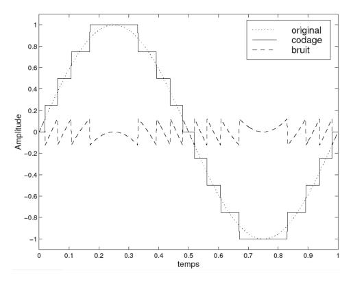
Une solution à ce problème est évidemment de s'assurer que les signaux sont échantillonnés avec un nombre suffisant de bits pour chaque prélèvement.
