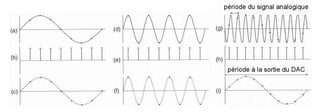
sinusoïdaux à l'entrée d'un convertisseur analogique-numérique (ADC), la deuxième ligne (b, e, h) représente les trains d'impulsions à la fréquence d'échantillonnage, et la troisième ligne (c, f, i) donnent les signaux reconstitués à la sortie du convertisseur numérique-analogique (DAC). Considérons un signal complexe composé des trois fréquences représentées sur les figures (a), (d) et (g) respectivement.
