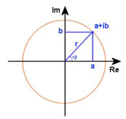
Autrement dit, multiplier par le nombre imaginaire i revient à appliquer une rotation de 90 degrés (dans le sens anti-horlogique). On peut aussi représenter un nombre complexe suivant ses coordonnées polaires. Les coordonnées sont alors l'amplitude r et l'angle  $\phi$ .
