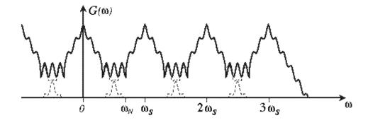
Pour éviter ce problème, il faut veiller à ce que le signal à échantillonner soit limité en fréquence. C'est pour cette raison qu'un convertisseur analogique-numérique comprend un filtre passe-bas anti-repliement à son entrée.
